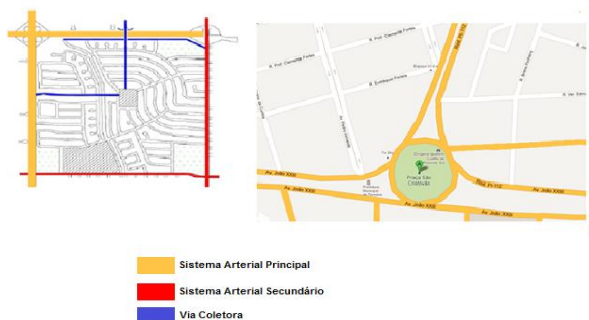
Figura 2 – Hierarquia funcional das vias urbanas (à esquerda) e dos locais a serem construídos os viadutos A e B (à direita)
