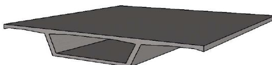
Figura 16 – Panorama do tabuleiro dos viadutos A e B em 3D
