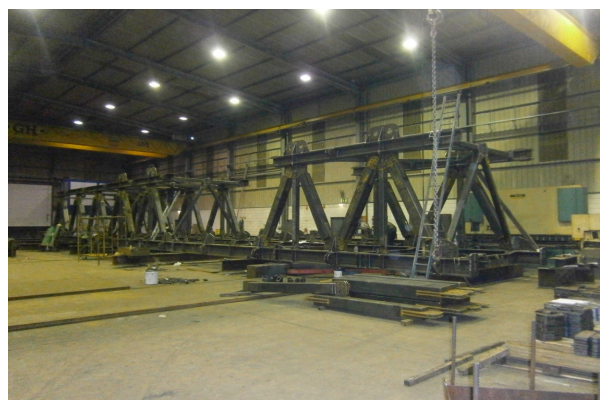
Figura 4.3 – Módulos de Viga
