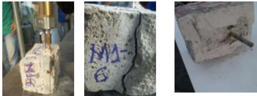
Figura 6: Ruptura por arrancamento da barra.
