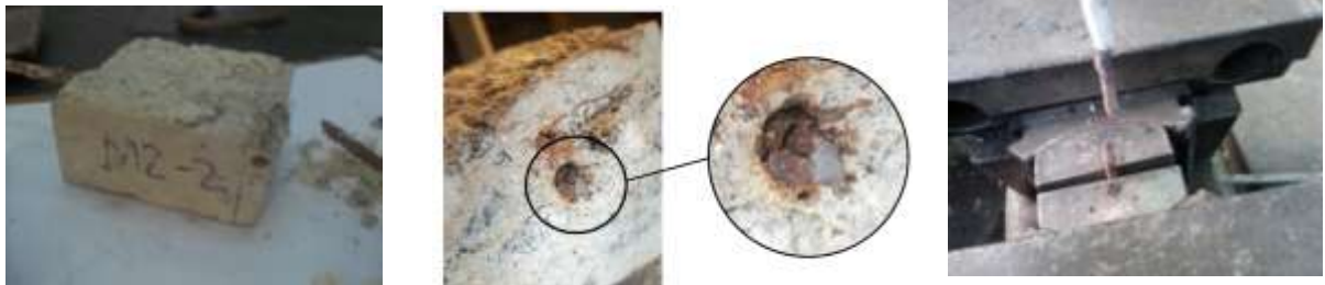
Figura 4: Ruptura do aço ao longo da barra ou no interior do modelo.
