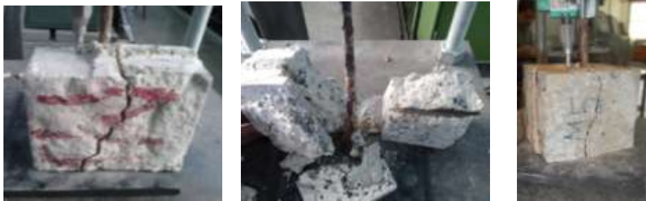
Figura 5: Ruptura por fendilhamento do concreto.
