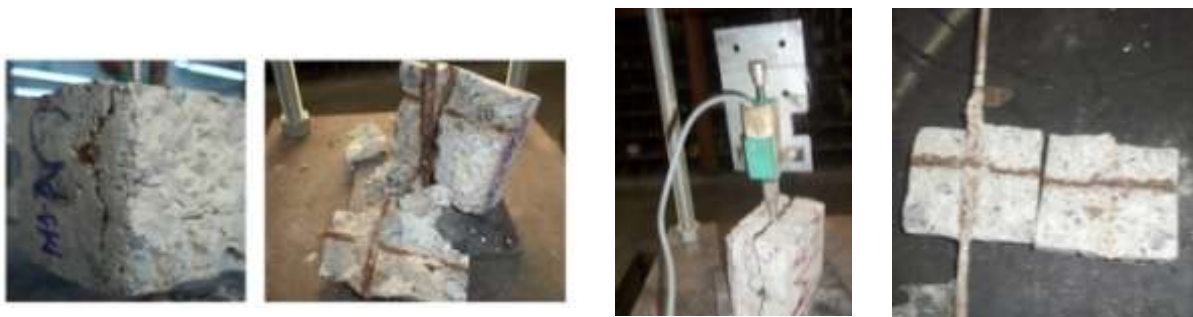
Figura 7: Ruptura por arrancamento / fendilhamento.
