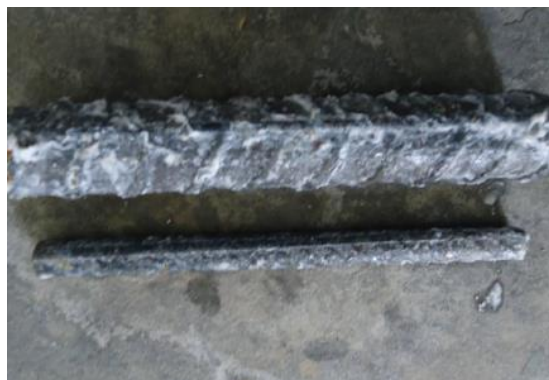
Figura 6 – Barras de aço galvanizado após exposição de 672 horas à névoa salina, ausência de corrosão vermelha.
