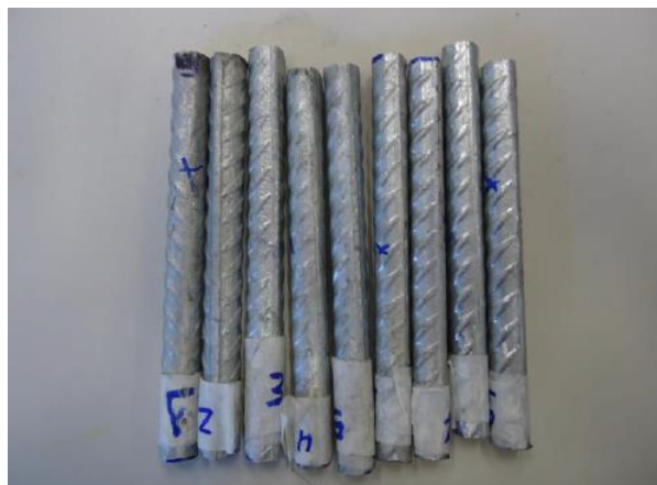
Figura 3 – Vergalhões galvanizados (bitola 10 mm) antes do ensaio.
