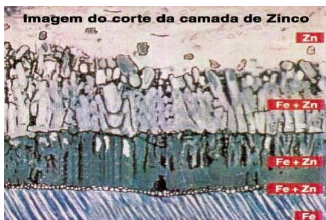
Figura 1 - Imagem do corte da camada de Zinco sobre o aço após galvanização.
