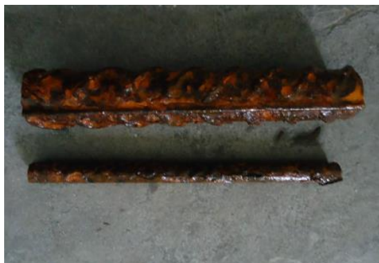
Figura 5 – Barras de aço comum após exposição de 672 horas à névoa salina, com intensa corrosão vermelha.
