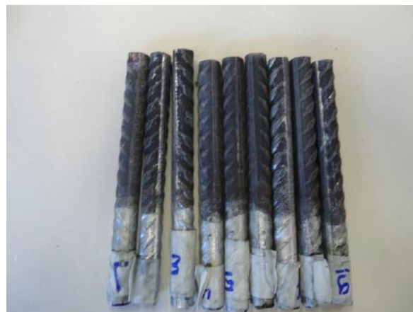
Figura 4 – Vergalhões galvanizados (bitola 10 mm) após ensaio – Não apresentou depósito.
