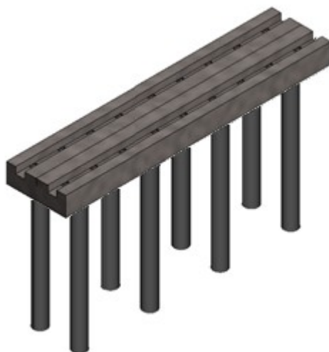
Figura 10 – Slab track estaqueado
