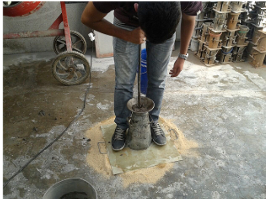
Figura 1: Execução do slump test (pessoal)
