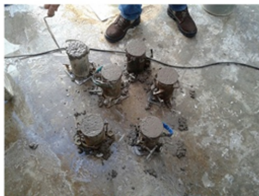
Figura 3: Moldagem dos corpos de prova do CVV e do CAA (pessoal)
