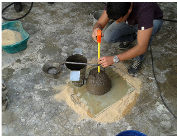
Figura 2: Medição do espalhamento no slump test (pessoal)
