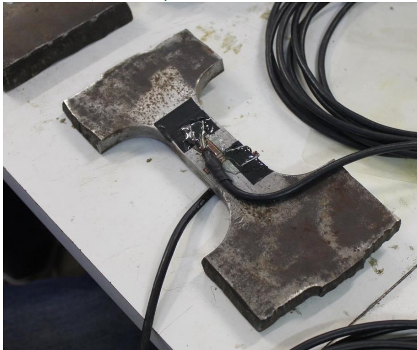
Figura 4 – Instalação de extensômetros em um dos CP's de aço
