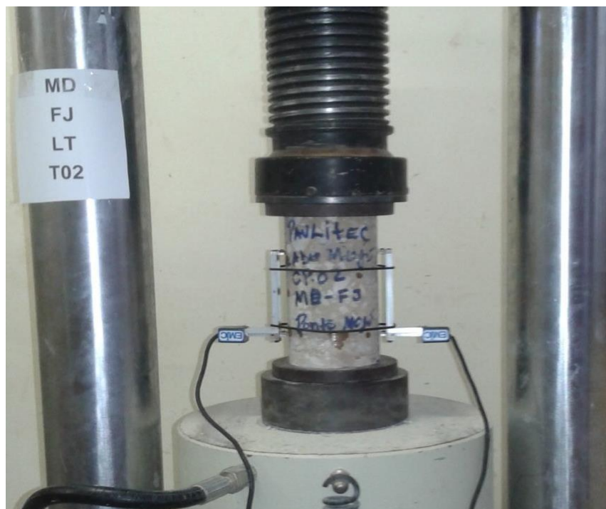
Figura 3 - Testemunho MD FJ LT T02 posicionado na máquina de ensaios
