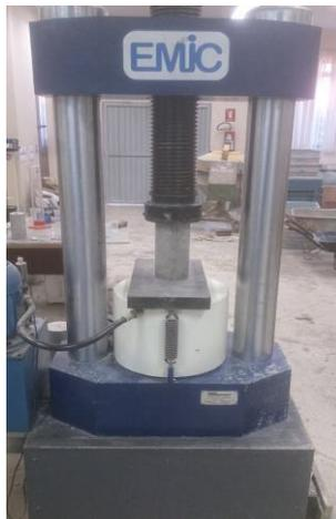
No ensaio de compressão axial não foi utilizado nenhum método de retificação ou capeamento nas faces dos corpos de prova, para a obtenção de uma superfície o mais lisa possível.
