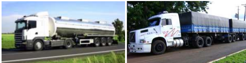
Figura 4 - Veículo 2S3 longo e 3D4, utilizado no transporte de combustíveis e no transporte de cargas pesas, respectivamente (fonte: Autor 2013)
