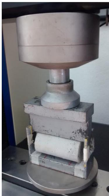
Figura 4 –Montagem para ensaio de tração por compressão diametral.
