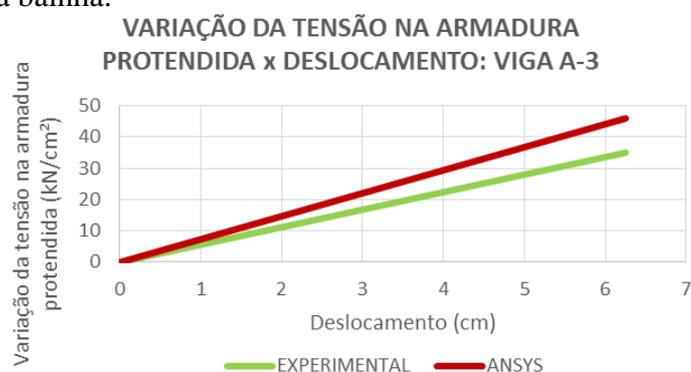
**Figura 7 – Variação das tensões na armadura ativa, obtida no ensaio experimental e no modelo computacional, para a viga A-3 de Gongchen e Xuekang (1988)**
