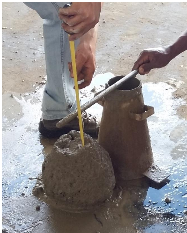
Figura 2- Execução do slump test
