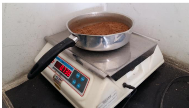
Figura 1- Execução de ensaio de umidade de areia
