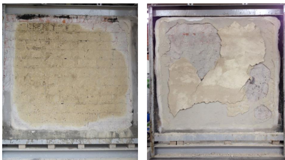
Amostra 1 Amostra 2 Figura 9 – Faces expostas ao fogo após o término dos ensaios
