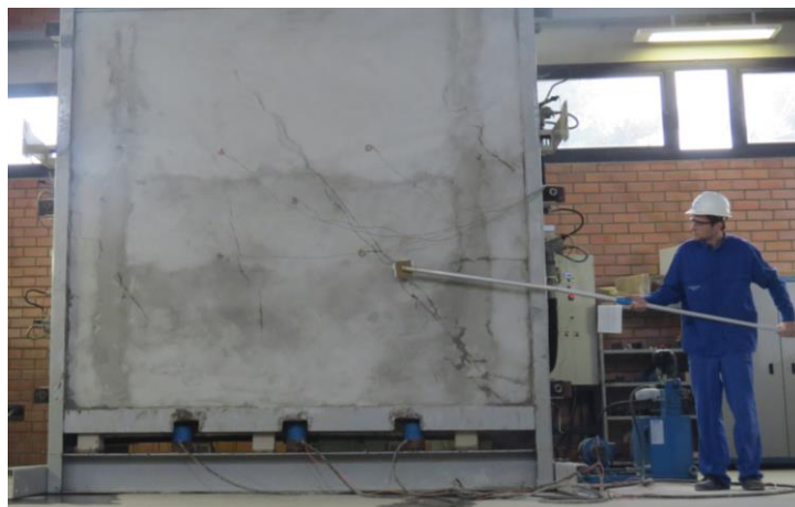
Figura 5 – Verificação da estanqueidade durante o ensaio
