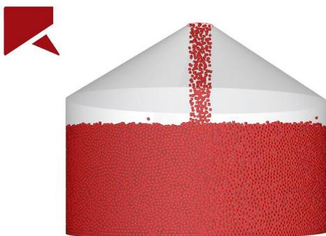
**Figura 4 – Enchimento do silo através da cúpula**
