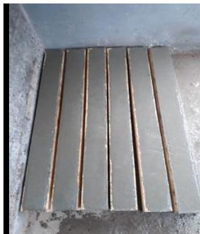
**Figura 2:** Protótipos pré-moldados de concreto armado
