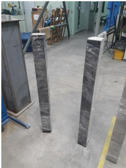
**Figura 3:** Protótipos de concreto revestidos com chapas de aço.
