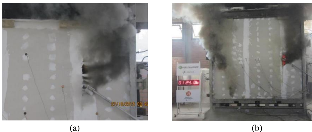
Figura 5 – Realização do teste de estanqueidade (a) na amostra A e (b) amostra B
