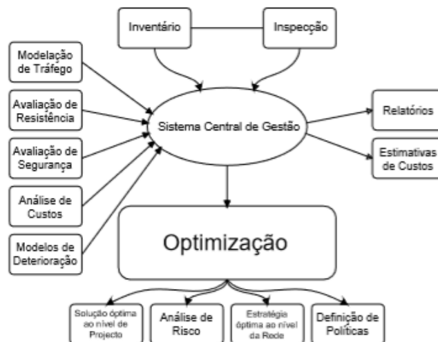
Figura 1 – Estrutura de um Sistema de Gestão de Obras de Arte Especiais (ALVES e COSTA, 2004).
