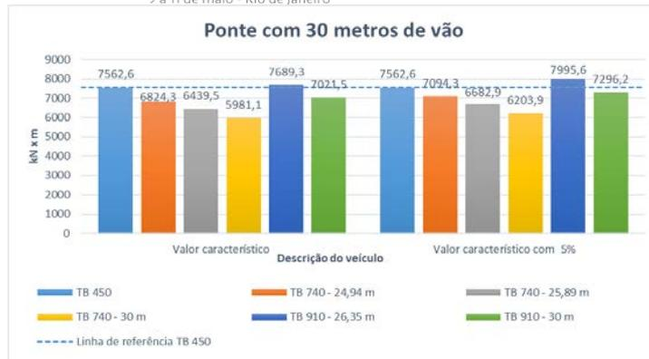
**Figura 12 – Gráfico demonstrativo da envoltória do momento fletor dos diversos trem-tipo em estudo, para ponte de 30 metros.**
