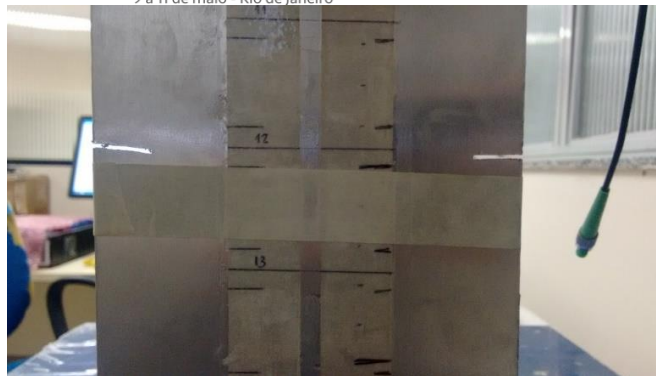
Figura 8 – Redução da Seção da barra do pórtico no ponto 12.
