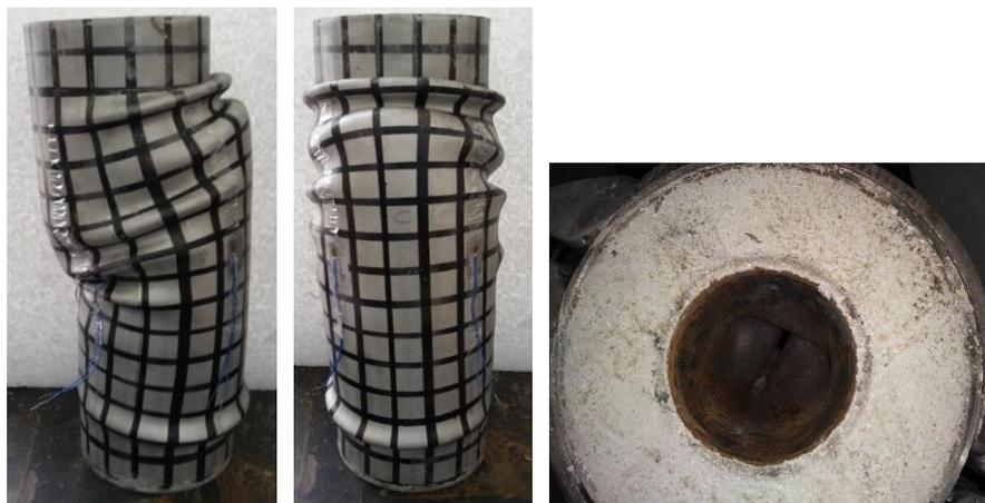
**Figura 5 – Modos de falhas da coluna C2**
