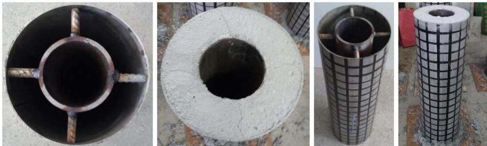
**Figura 2 – Seções transversais e protótipos – antes e depois da concretagem**
