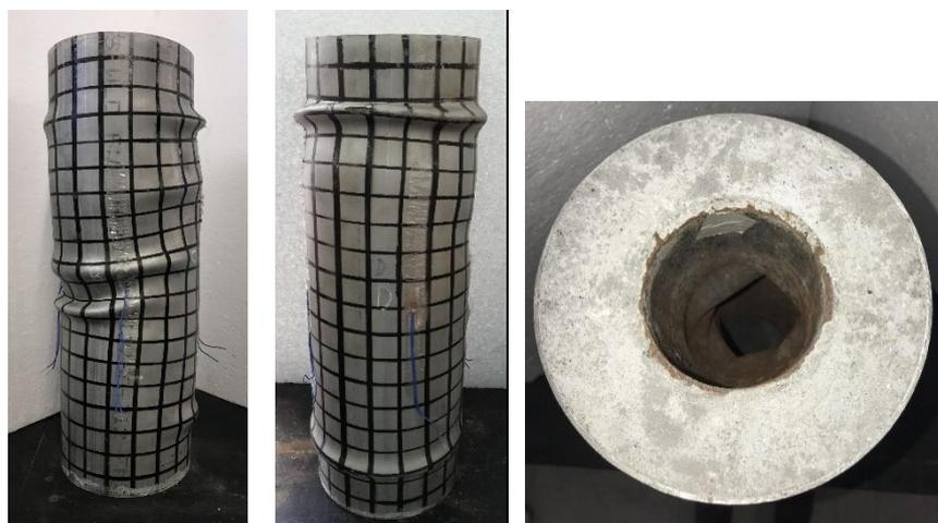
**Figura 4 – Modos de falhas da coluna C1**
