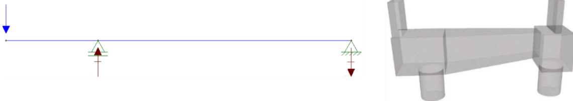
Figura 3 - Viga de equilíbrio
