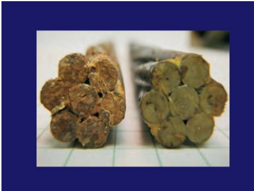
Fig. 9 Amostras de Cabo Com e Sem o Material de Impregnação
