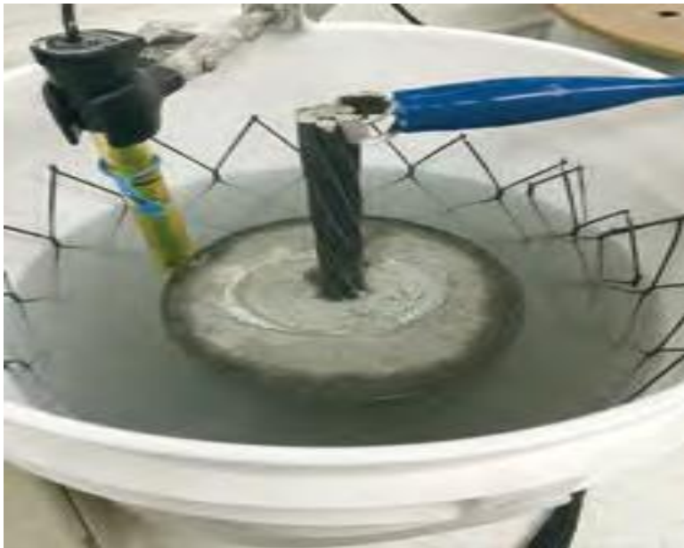
Fig.10 Teste Potenciostático de Corrosão para Comprovar a Eficiência do Fluido de Impregnação dos Cabos Pós-Tensionados
