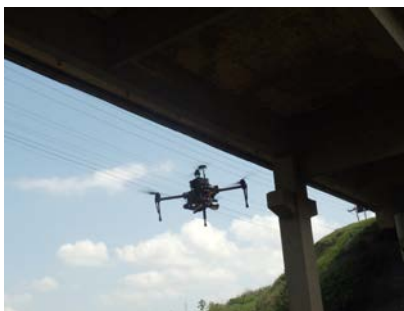
Figura 2 - Inspeção de OAE por Drone
