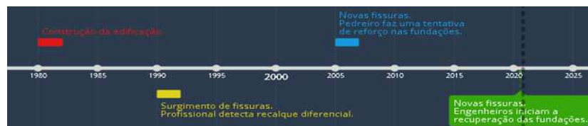
Figura 4 – Linha do tempo do surgimento de problemas estruturais na edificação. Fonte: Autoras (2020).
