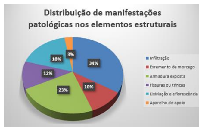
Figura 7 – Distribuição de manifestações patológicas nos elementos estruturais.
