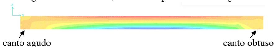
**Figura 20 - Desvio das tensões máximas na longarina na direção do canto obtuso.**
