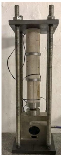
Figura 2 – Pórtico utilizado para o ensaio de fluência a compressão em amostras cilíndricas.
