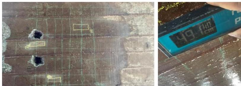
**Figura 4 – Realização do ensaio de resistividade superficial do concreto.**
