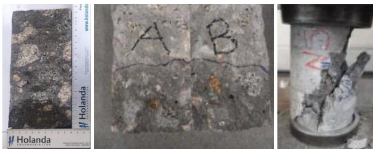
**Figura 6 – Realização dos ensaios de determinação da penetração de água sob pressão, determinação da absorção de água por capilaridade e determinação da resistência a compressão axial, respectivamente.**
