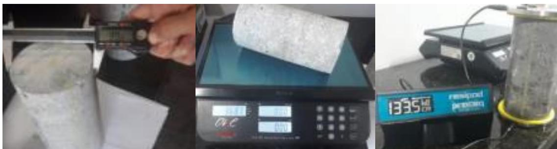
**Figura 5 – Realização do ensaio de resistividade volumétrica dos testemunhos de concreto.**
