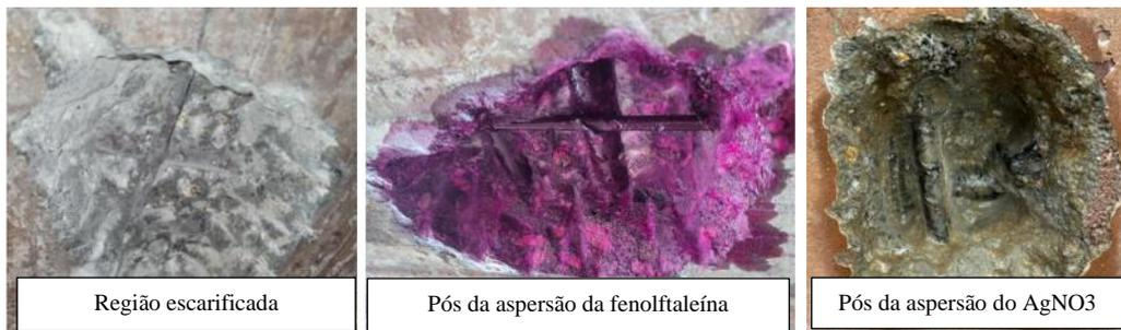
**Figura 3 – Ensaio de avaliação da frente de carbonatação e profundidade de penetração de cloretos no concreto com aspersão de fenolftaleína e  $\text{AgNO}_3$ , respectivamente.**
